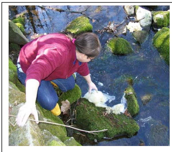
Figura 2 = Campionamento acque schiume organiche (tensioattivi), lungo il corso d'acqua. Loc. Molera di Briosco (MB)
