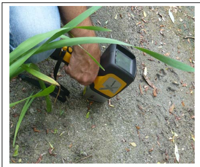
Figura 1 = Controllo sedimenti direttamente nel torrente (Rio Fossarone) con strumento X-Ray portatile
